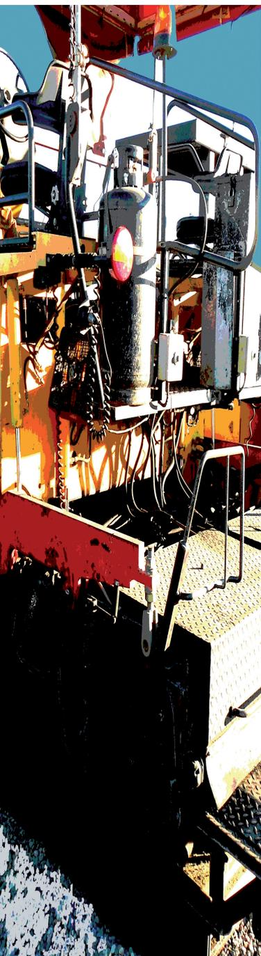
Le finitrici rientrano nella categoria delle macchine operatrici utilizzate per la realizzazione delle opere stradali ed affini, in particolare sono usate per la realizzazione della pavimentazione stradale, per la stesura del conglomerato bituminoso necessario per la formazione dello strato di base e del tappetino di usura.
